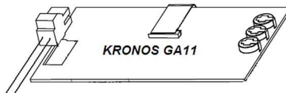
Verbindung zum Warmluftferzeuger
